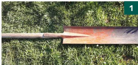
Bêche de drainage dont le fer mesure 10 cm de large par 55 cm de hauteur.
